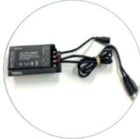
Placer le récepteur entre le boîtier d'alimentation et les rubans LED
